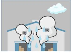
低気圧の接近、温暖前線の通過により、暖かく湿った空気（露点温度の高い空気）が倉庫内に流入し、結露が発生する。
